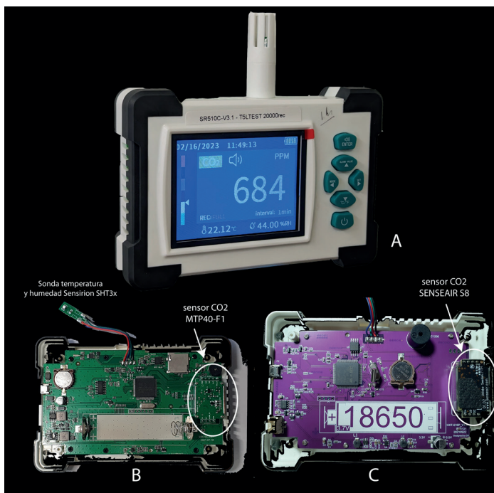
Foto 1. A medidor datalogger de CO 2 , temperatura y humedad (EcoDeyi). B Sensor CO 2 modelo MTP40-F1. C Sensor CO 2 modelo SENSEAIR S8.
